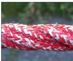
Abbildung 5: Beispiele für die Entwicklung der Seiloberfläche im Betrieb
