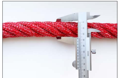
Abbildung 9: Flach liegender Messschieber zur korrekten Ermittlung des Seildurchmessers
