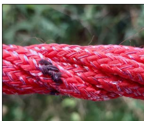
Abbildung 5: Beispiele für die Entwicklung der Seiloberfläche im Betrieb
