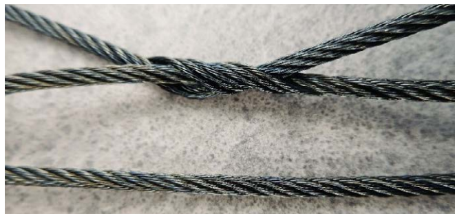
Bild 2: Oberflächen-Details bleiben erhalten, da die Werkstücke beim Spektralfärben nicht beschichtet werden.
